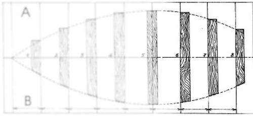
2 - Le placement effectué, il y a lieu de procéder au ponçage de l'ensemble de manière à ce que le bordé à venir, s'appuie correctement sur chaque section et reproduise ainsi la courbe de la coque (voir B).
